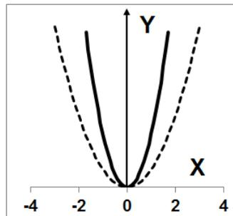
Der tiefste Punkt bei einer nach oben offenen bzw. der höchste Punkt einer nach unten offenen Parabel heißt **Scheitel**. Für eine Funktion  $y = a x^2$  hat der Scheitel die Koordinaten  $S(0 | 0)$ .
